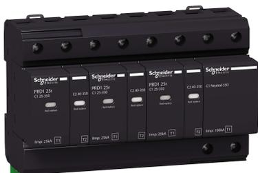
parafoudres de type 1 à cartouches débrochables, destinés aux installations exposées à un niveau de risque maximal (présence d'un paratonnerre) avec report à distance de l'information «cartouche à changer».
