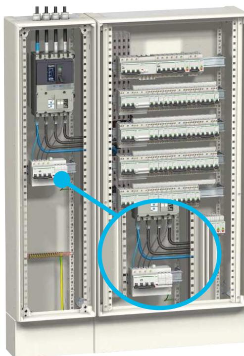
Armoire Prisma avec jeu de barres Powerclip et gaine. Le conducteur de terre principal arrive par le bas. Le conducteur de terre du parafoudre est relié au plus près à la structure du coffret (veiller à s'assurer de la continuité de masse). Le parafoudre est installé dans la gaine au plus près de la protection de tête.
