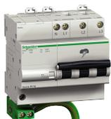
parafoudres monoblocs de type 2 à cartouche fixe avec dispositif de déconnexion intégré (disjoncteur). Ces parafoudres sont conçus pour le schéma de liaison à la terre (régimes de neutre) TT dans le résidentiel et le petit tertiaire
