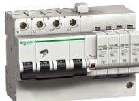
parafoudres monoblocs de types 2 et 3 à cartouche débrochable avec dispositif de déconnexion intégré (disjoncteur) et report à distance de l'information "cartouche à changer". Ces parafoudres sont conçus pour les schémas de liaison à la terre (régimes de neutre) TT, TNS ou TNC dans le tertiaire
