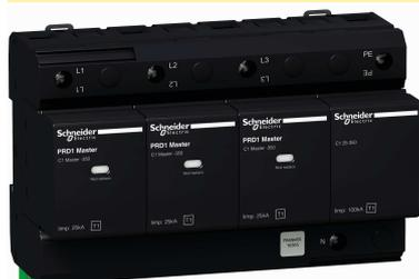
parafoudres de type 1 à cartouches débrochantes, destinés aux installations exposées à un niveau de risque maximal (présence d'un paratonnerre) avec report à distance de l'information «cartouche à changer».
