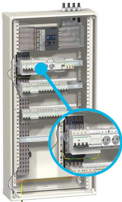
Coffret Prisma avec jeu de barres Powerclip et arrivée de la terre principale par le bas. Le conducteur de terre du parafoudre est relié au plus près à la structure du coffret (veiller à s'assurer de la continuité de masse).
